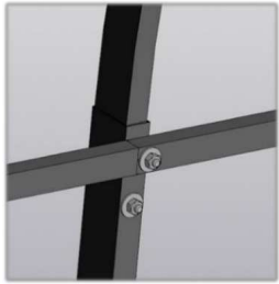
Pav. 3.1 – Lankų ir skersinių tvirtinimas šiltnamio viduje
